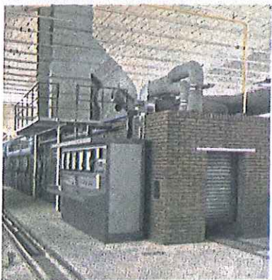
Hornos a túnel para bizcocho, esmaltado y gres por monococción.
