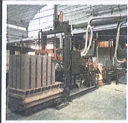
Prensas automáticas a fricción e hidráulicas, y recogedores - cargadores automáticos so- bre vagonetas.
